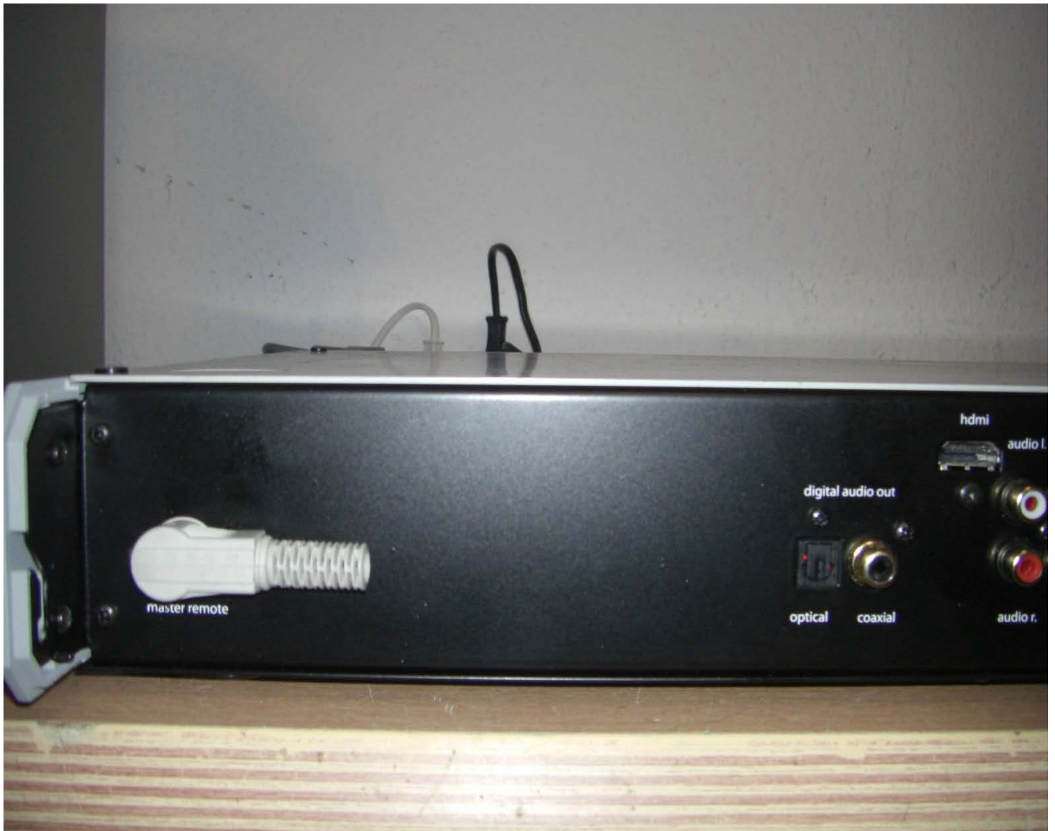
Teilansicht der Rückwand mit den digitalen Video und Audio Anschlüssen, sowie der Master Remote Buchse
